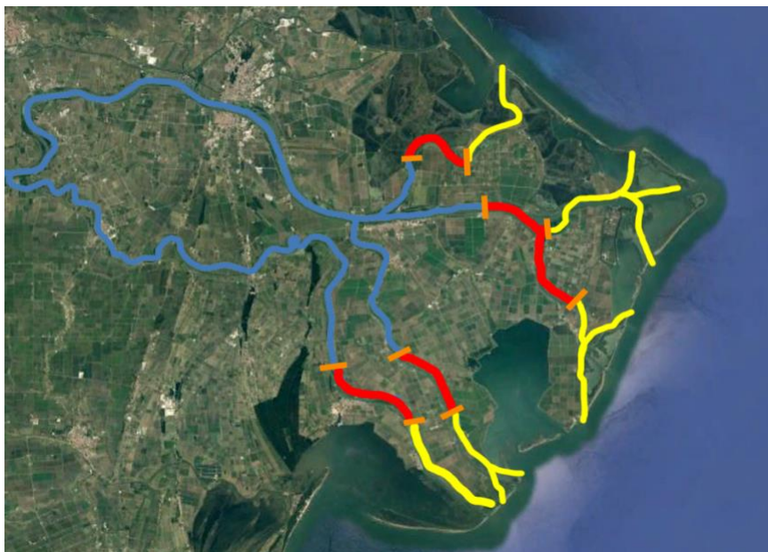
Rappresentazione dell'attuale risalita del cuneo salino nel Delta del fiume Po con bassa marea (in giallo) e alta marea (in rosso)
