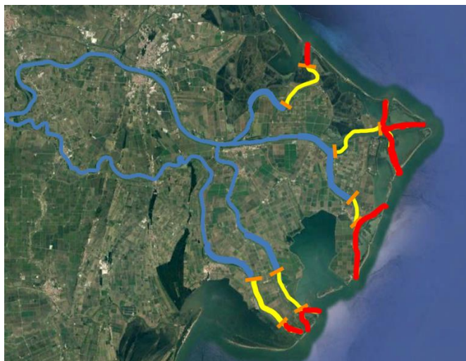
Rappresentazione dell'attuale risalita del cuneo salino nel Delta del fiume Po con bassa marea (in giallo) e alta marea (in rosso)
