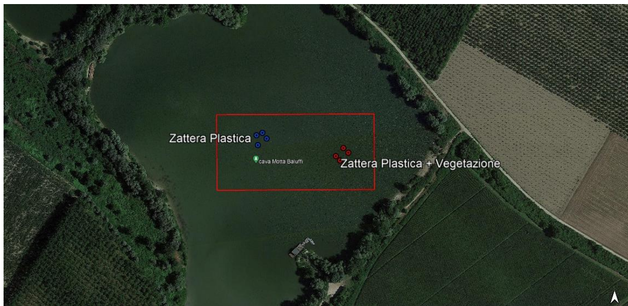
Figura 93. Area studio. Il rettangolo di colore rosso delimita l'area sottoposta alle analisi, mentre i punti di colore blu corrispondono ai punti GPS RTK della zattera di sola plastica, quelli rossi alla zattera di plastica con vegetazione.
